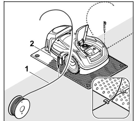
Begrenzungsdraht (1) **links** oder **rechts** neben der Bodenplatte, direkt neben einem Drahtauslass mit einem Fixiernagel (2) am Boden befestigen.
