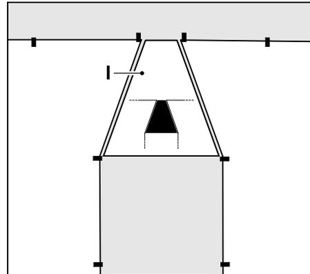
Zur Installation der trichterförmigen Ein- und Ausfahrt auch die mitgelieferte Gassenschablone (I) verwenden.
