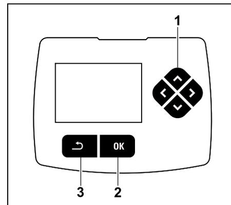
Das Steuerkreuz (1) dient zur Navigation in den Menüs, mit der OK-Taste (2) werden Einstellungen bestätigt und Menüs geöffnet. Mit der Zurück-Taste (3) können Menüs wieder verlassen werden.
