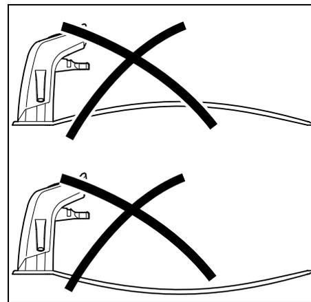
Bodenplatte niemals durchbiegen. Unebenheiten unter der Bodenplatte sind zu beseitigen, damit sie vollständig aufliegen kann.
