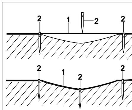
Der Begrenzungsdraht (1) wird oberirdisch verlegt und bei Unebenheiten mit zusätzlichen Fixiernägeln (2) befestigt. Dadurch wird verhindert, dass der Draht vom Mähmesser durchgeschnitten wird.
