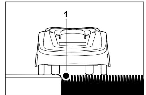
Entlang von befahrbaren Hindernissen wie Terrassen und befahrbaren Wegen kann der Begrenzungsdraht (1) **ohne Abstand** verlegt werden. Der Mähroboter fährt dann mit einem Hinterrad außerhalb der
