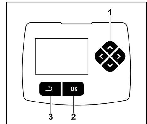
Vier Richtungstasten bilden das Steuerkreuz (1). Es dient zur Navigation in den Menüs, mit der OK-Taste (2) werden Einstellungen bestätigt und Menüs geöffnet. Mit der Zurück-Taste (3) können Menüs wieder verlassen werden.
