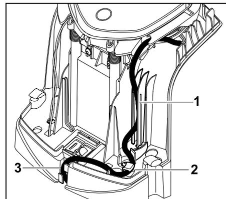
Stromkabel wie abgebildet in die Kabelführung (1) eindrücken und weiter durch die Zugentlastung (2) und den Kabelkanal (3) zum Netzteil führen.
