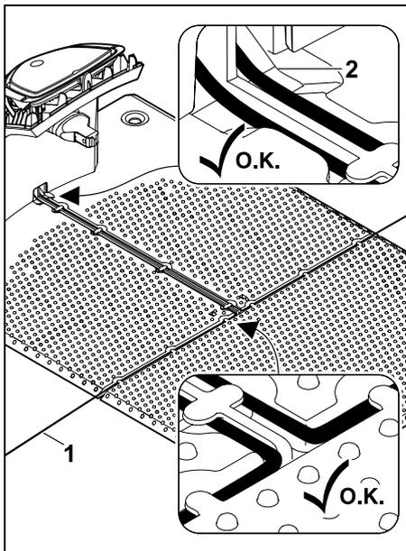
Begrenzungsdraht (1) in Kabelführungen der Bodenplatte einlegen und durch Sockel (2) fädeln.
