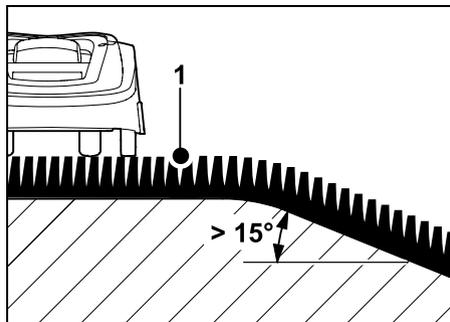
Befindet sich in der Mähfläche ein abfallender Bereich mit einem Gefälle > 15°, in der ein Begrenzungsdraht verlegt werden soll, wird empfohlen, den Begrenzungsdraht (1) wie abgebildet in der ebenen Fläche oberhalb der Geländekante zu verlegen. Die Geländekante und der abfallende Bereich werden nicht gemäht.
