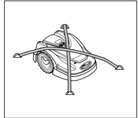
Rasenmäher auf der Ladefläche sichern. Dazu Gerät wie abgebildet mit geeigneten Befestigungsmitteln (Gurte, Seile) fixieren.
