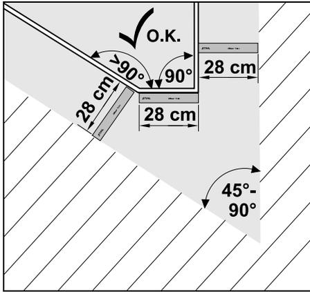
In spitz zulaufenden Rasenecken (45° - 90°) wird der Begrenzungsdraht wie abgebildet verlegt. Die beiden Winkel müssen einen Abstand von mindestens **28 cm** haben, damit der Mähroboter den Rand abfahren kann.
