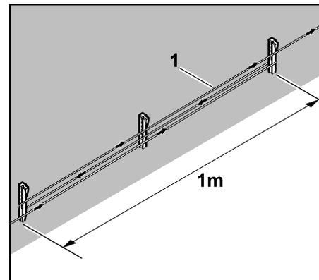
Begrenzungsdraht (1) über eine Länge von ca. 1 m zwischen 2 Fixiernägeln wie abgebildet verlegen. Drahtreserve in der Mitte mit einem weiteren Fixiernagel am Boden festmachen.
