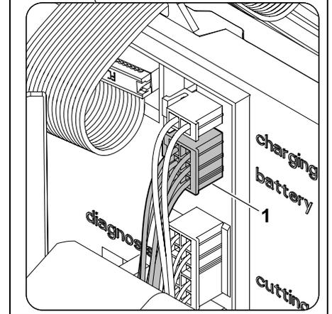
Kabelstecker (1) (battery) abziehen.
