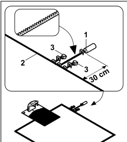
AKM 100 (1) mit 30 cm Abstand außerhalb der Mähfläche mit einem Fixiernagel befestigen. Drahtenden bis zur Mähfläche verdrehen und mit einem Fixiernagel befestigen.
