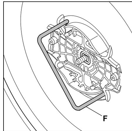
Abzieher (F) einführen und bis zum Anschlag gegen den Uhrzeigersinn drehen.
