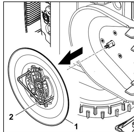
Gerät mit einer Hand abstützen. Mitnehmerscheibe (1) durch Ziehen am Abzieher (2) abziehen.
