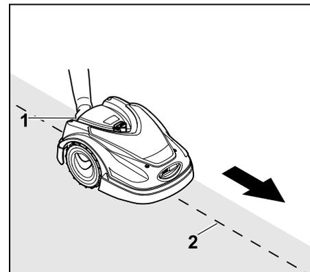
Mit dem Mähroboter ausgehend von der Dockingstation den Rand der Mähfläche **im Uhrzeigersinn** abfahren. Dazu Gerät am Tragegriff hinten (1) etwas anheben, um die Antriebsräder zu entlasten. Mit dem auf die Vorderräder aufgestützten Mähroboter dem Begrenzungsdraht (2) folgen. Es ist darauf zu achten, dass der Begrenzungsdraht (2) unter den Drahtsensoren verläuft. Die Drahtsensoren sind geschützt links und rechts im vorderen Bereich des Mähroboters montiert.
