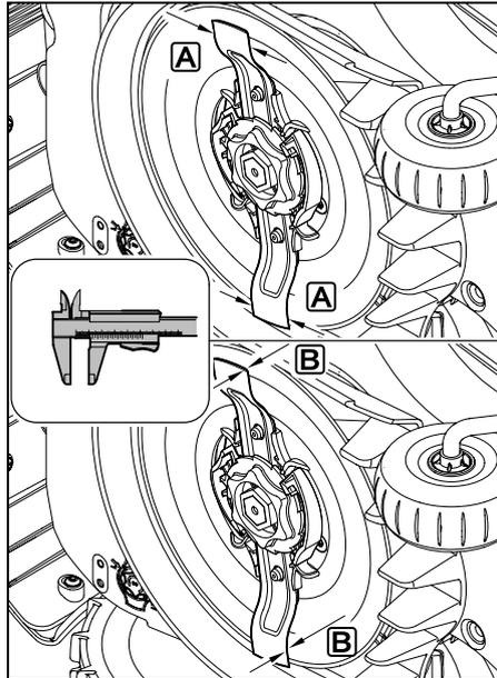
**Messerbreite A** und **Messerstärke B** mit einem Messschieber prüfen.
