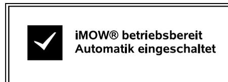
Im unteren Bereich der Anzeige werden der Text "iMOW® betriebsbereit" zusammen mit dem abgebildeten Symbol und der Automatik-Status angezeigt. (⇒ 11.7)
