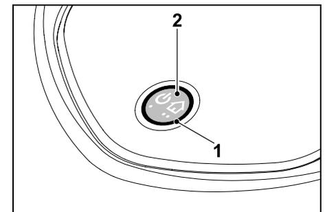
Eine ringförmige, rote LED (1) informiert über den Status der Dockingstation und des Drahtsignals.
