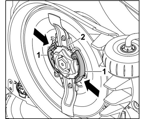
Beide Laschen (1) an der Mitnehmerscheibe mit einer Hand eindrücken und halten. Fixiermutter (2) mit der anderen Hand ausdrehen. Mähmesser zusammen mit Fixiermutter entnehmen.
