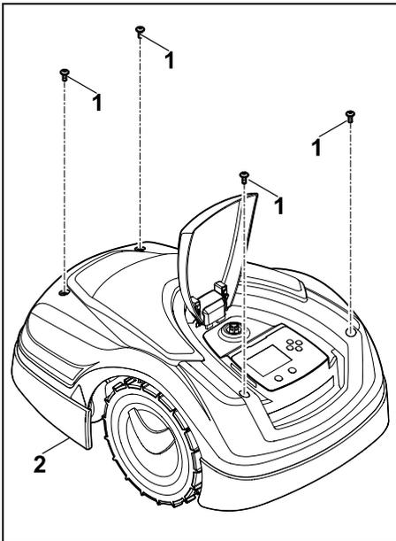
Schrauben (1) an der Abdeckung (2) ausdrehen und entnehmen.
