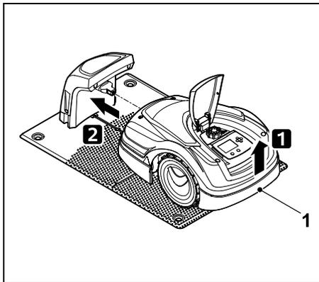
Mähroboter am Tragegriff (1) etwas anheben, um die Antriebsräder zu entlasten. Gerät auf die Vorderräder aufgestützt in die Dockingstation schieben.
