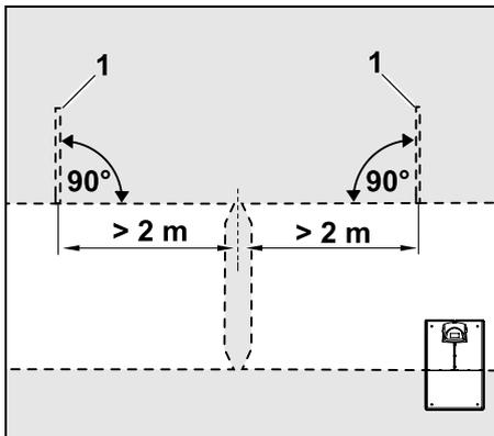
Links und rechts neben der Gasseneinfahrt sind zwei Suchschleifen (1) in einem Winkel von 90° zum Begrenzungsdraht zu installieren,
