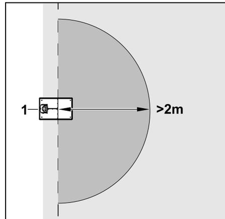
Damit das Eindocken nicht gestört wird, darf im Umkreis von mindestens **2 m** um die Dockingstation (1) keine Sperrfläche installiert werden.
