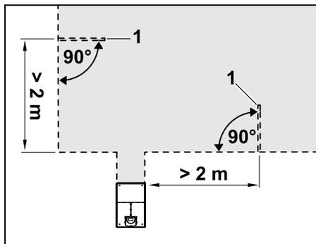
Suchschleifen dürfen nicht im Nahbereich von Ecken installiert werden. Mindestabstand zu Ecken: 2 m
