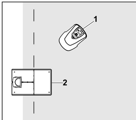
Mähroboter (1) wie abgebildet hinter der Dockingstation (2) innerhalb der Mähfläche abstellen, anschließend OK-Taste drücken. **OK**
