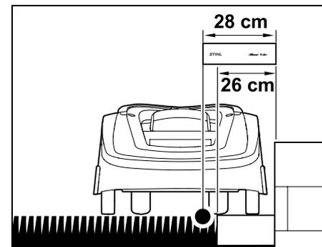
Begrenzungsdraht mit 28 cm Abstand vom Hindernis entfernt verlegen. Damit die Rasenkante vollständig gemäht wird, müssen die Randsteine mindestens 26 cm breit sein. Werden breitere Randsteine verlegt, wird die Rasenkante noch exakter bearbeitet.
