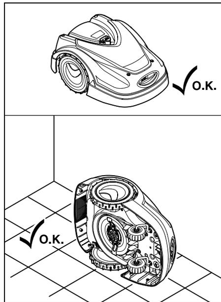
Zum Reinigen der **Geräteoberseite** (Haube, Klappe) Gerät auf einem ebenen, festen und waagrechten Untergrund abstellen. Zum Reinigen der **Geräteunterseite** (Mähmesser, Mähwerk) Mähroboter wie abgebildet auf die linke oder rechte Geräteseite aufkippen und gegen eine Wand lehnen.
