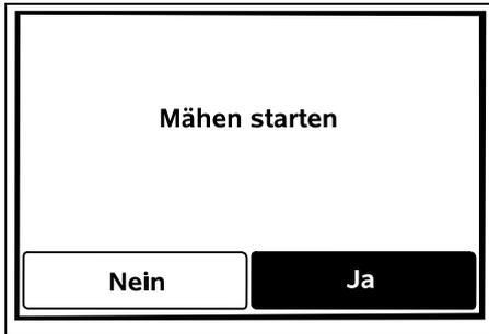
Falls der Abschluss der Erstinstallation außerhalb der Aktivzeit erfolgt, kann durch Drücken der OK-Taste ein Mähvorgang gestartet werden. Falls der Mähroboter nicht mähen soll, "Nein" auswählen.
