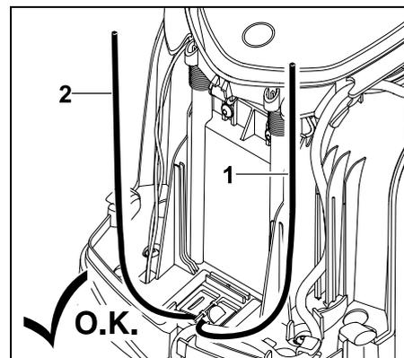
Linkes Drahtende (1) und rechtes Drahtende (2) auf dieselbe Länge kürzen. Länge vom Drahtauslass bis zum Drahtende: **40 cm**
