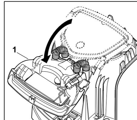
Panel (1) nach vorne aufklappen. Panel in aufgeklappter Position halten, weil es aufgrund der Scharnierfedern selbständig zuklappt.
