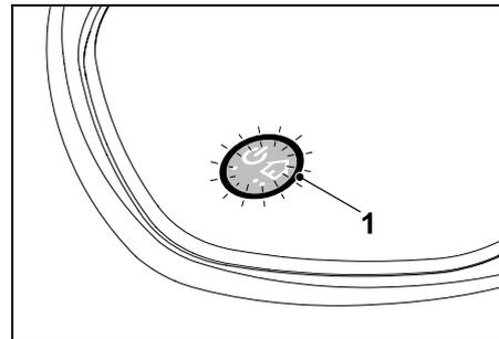
Wenn der Begrenzungsdraht korrekt installiert und die Dockingstation an das Stromnetz angeschlossen ist, leuchtet die LED (1).
