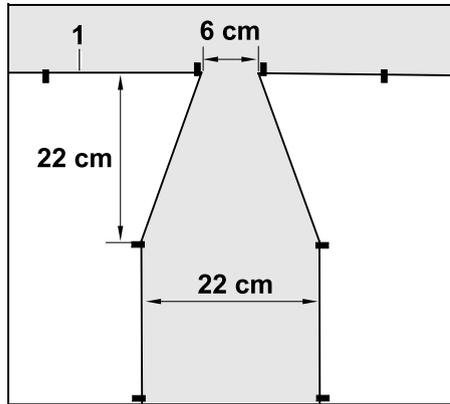
Am Anfang und am Ende einer Gasse ist der Begrenzungsdraht (1) wie abgebildet trichterförmig zu verlegen. Dadurch wird vermieden, dass der Mähroboter während des Mähvorgangs unbeabsichtigt in die Gasse fährt.
