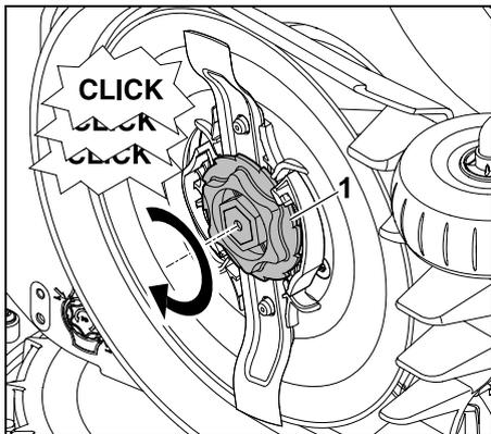
Fixiermutter (1) bis zum Anschlag aufschrauben. Während des Festziehens sind mehrere Click-Geräusche hörbar. Den sicheren Sitz des Mähmessers durch vorsichtiges Rütteln kontrollieren.
