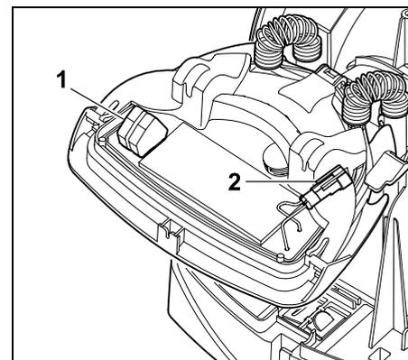
Die Anschlüsse für den Begrenzungsdraht (1) und das Stromkabel (2) sind bei geschlossenem Panel gegen Witterungseinflüsse geschützt.
