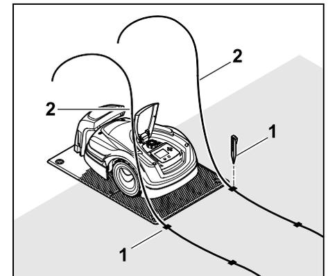
Den letzten Fixiernagel (1) links bzw. rechts hinter der Bodenplatte, direkt neben dem Drahtauslass einschlagen. Begrenzungsdraht (2) auf ca. 2 m freie Länge abschneiden.
