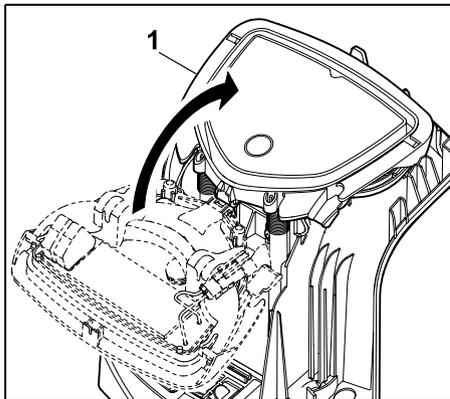
Panel (1) nach hinten zuklappen – keine Kabel einklemmen.
